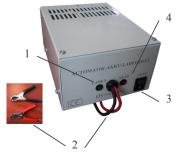
Most kapcsolja be a hálózati kapcsolót (I állás) {3}. Gépjármű akkumulátorok töltésénél kössük le a jármű akkumulátor kábeleit a töltés idejére. Figyelem: üzembiztonsági okokból a csipeszeken nem jelenik meg a töltőfeszültség, ameddig nem csatlakoztatjuk azokat az akkumulátorra.
